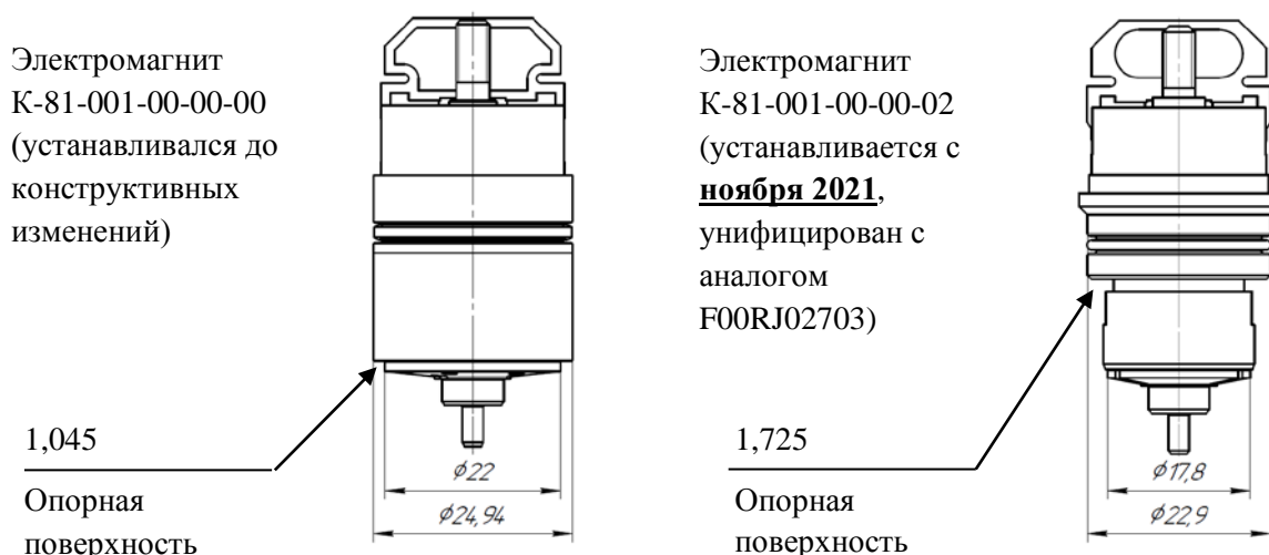
Рисунок 1. Электромагнит.
